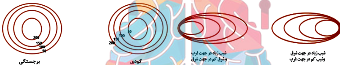
شکل ۳۱: گودی، برجستگی، شیب زیاد و شیب کم در منحنی‌های میزان
