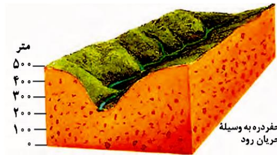
شکل ۱۴: ایجاد دره V شکل در اثر فرسایش آبی
